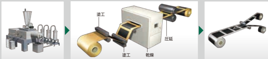
④ 計量・混練 正極材・負極材の適正量を量り、材料ごとに混ぜあわせペースト状にします。 ⑤ 塗工・乾燥・圧延 電極材を金属箔へ均一に塗布します。塗布した電極材を熱風吐出と、湿気の急速吸引により、高速乾燥します。電極をローラで圧延し密度を高めます。 ⑥ スリット 電極材料及セパレータのロールを適当な大きさにカットします。
